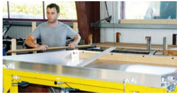
Herstellung des Kollektorgehäuses.
