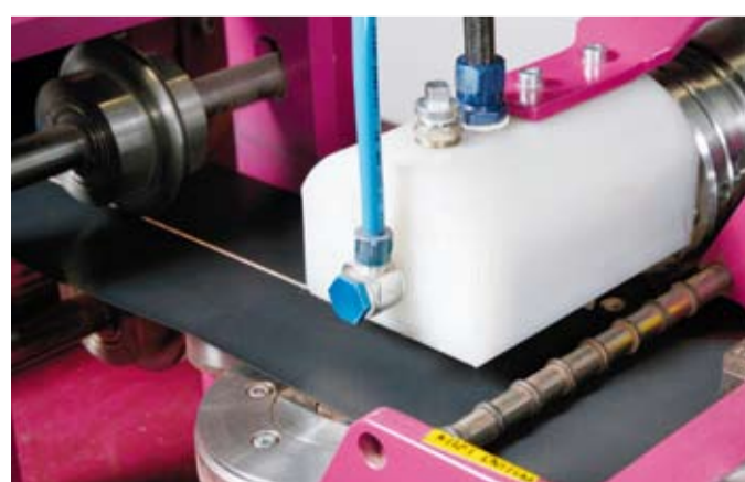
Das eigen entwickelte Ultraschall-Schweissmodul auf der Produktionsstrasse.
