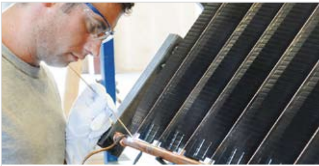
Die Absorberstreifen werden von Hand mit den Sammelrohren verlötet.
