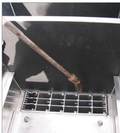
12. Alkalische Reinigung des Wärmetauschers mit geeigneten Reinigungsmittel
